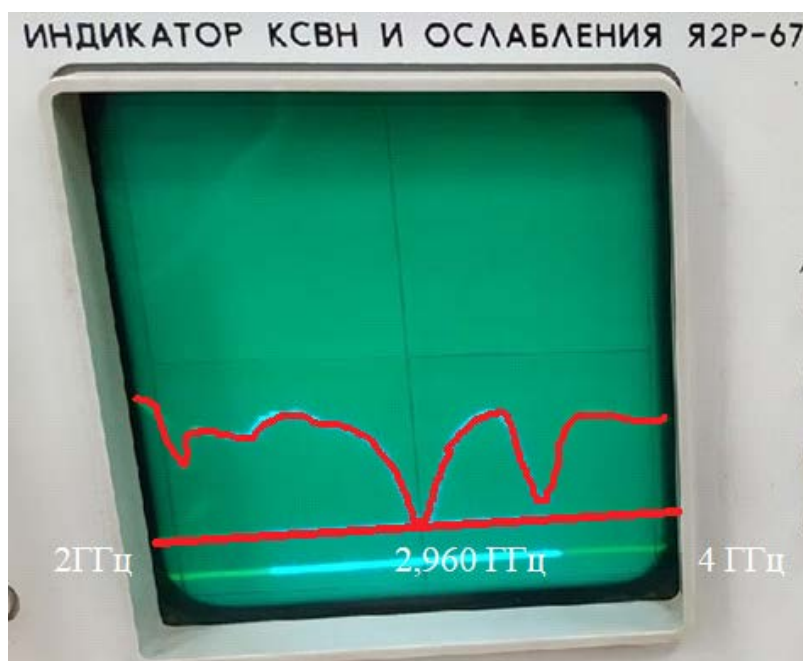
Рисунок 12. Измерения на индикаторе КСВН и ослабления Я2Р-67 для второго макета с меньшим раскрывом.
